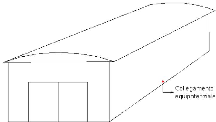
Si prevede collegamento equipotenziale (Resistenza verso terra < 200 Ω)
